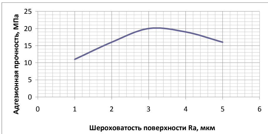
Рисунок 1 – Зависимость адгезионной прочности «МКМ-сталь» от шероховатости поверхности, полученной шлифованием.
